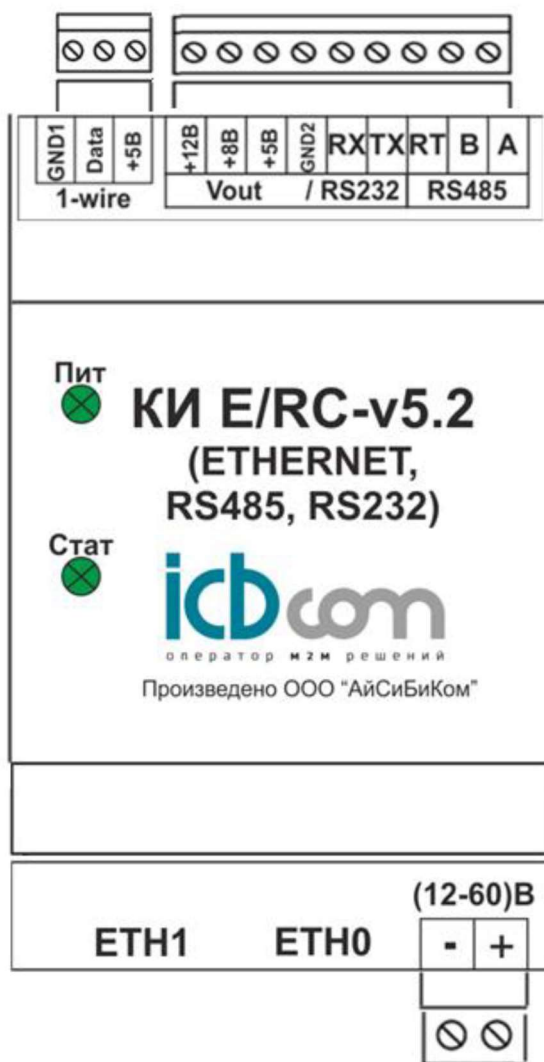
Рисунок 1 – Схема устройства с обозначением разъемов
